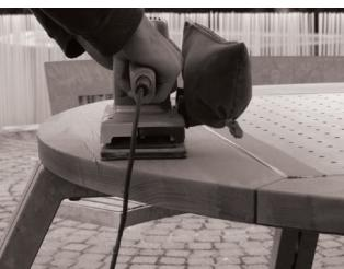
Levigare quindi il piano superiore. Prestare attenzione che la levigatrice sia tenuta parallela al piano del tavolo. Non trattare soltanto i punti rovinati, ma l'intero tavolo al fine di ottenere un risultato uniforme.
