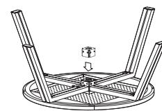
3. Platzieren Sie den zentralen Kubus in der Tischmitte zwischen den 4 Beinen. Positionieren Sie den Kubus derart, dass die komplett offene Seite auf die Tischplatte hin gerichtet ist. Befestigen Sie den Kubus mit Hilfe der 8 kurzen Bolzen und Muttern an den Beinen. Die Muttern werden auf der Innenseite des Kubus angebracht. Ziehen Sie die Bolzen aber noch nicht ganz fest.
