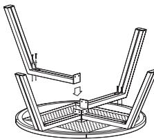
2. Coloque las 4 patas en su sitio con la chapa soldada mirando hacia el medio. Sujete las patas con los 8 tornillos largos y las arandelas planas. Asegúrese de que los tornillos no queden todavía completamente enroscados!
