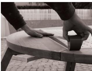
Possibles fisuras pueden restaurarse fácilmente a mano con una hoja de papel de lija o utilizando una lijadora de mano. Aplique en el borde de la parte central inox una cinta adhesiva muy fuerte para protegerla.
