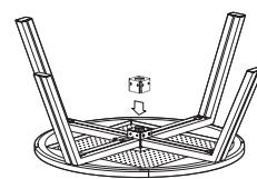
3. Posizionare il cubo centrale nel centro della tavola tra le quattro gambe. Il cubo deve essere posizionato con il lato completamente aperto rivolto verso il piano del tavolo. Fissare il cubo alle gambe utilizzando gli 8 bulloni corti ed i dadi. I dadi devono essere posizionati all'interno del cubo. Non serrare completamente i bulloni in questa fase!
