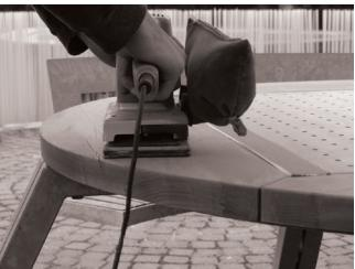
Scheuern Sie nun die Tischplatte. Achten Sie darauf, dass Sie die Maschine parallel zur Tischplatte halten. Behandeln Sie nicht nur die gerissene Stelle, sondern die ganze Platte, um ein gleichmäßiges Ergebnis zu erhalten.
