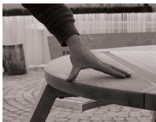
Per evitare bavature, levigare il bordo superiore del piano del tavolo. Trattare tale parte a mano. Se sono state eliminate tutte le bavature, è possibile, a seconda dell'effetto desiderato, passare sul tavolo dell'olio per legno duro.
