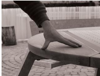
Um Schleifspuren zu vermeiden, scheuern Sie den oberen Rand der Tischplatte glatt. Erledigen Sie diesen Teil mit der Hand. Wenn alle unebenen Stellen ausgebessert sind, können Sie, je nach dem gewünschten Effekt, den Tisch mit Hartholzöl einölen.
