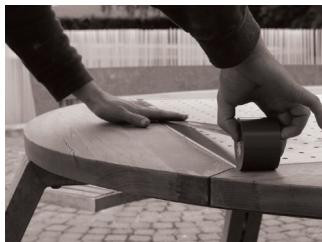
Sie können mögliche Risse auf einfache Weise mit der Hand und einem Blatt Scheuerpapier oder mit einer Handscheuermaschine glatt scheinern. Um die rostfreie Fläche zu schützen, kleben Sie den Rand mit einem sehr festen Band ab.
