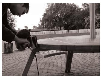
Utilice papel de lija de granulado 80 y comience la operación de lijar al nivel de la cara vertical del tablero. Mantenga la lijadora paralela al borde de la mesa. Lije suavemente hasta que se consiga una textura fina del borde.
