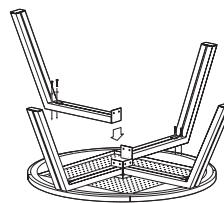
2. Legen Sie die vier Tischbeine mit der angeschweißten Platte zur Mitte hin auf ihren Platz. Befestigen Sie die Tischbeine mit den 8 langen Bolzen und den Unterlegscheiben. Ziehen Sie die Bolzen aber nicht ganz fest!
