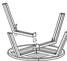
2. Mettere in posizione le quattro gambe, con la lamina saldata rivolta verso il centro. Fissare le gambe per messo degli 8 bulloni lunghi e delle rondelle piatte. Non serrare completamente i bulloni in questa fase!
