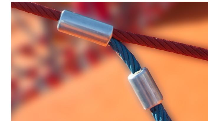
**Tek parça alüminyum döküm konektörler, ipin hareket etmesini ve erken aşınmayı önlemek için 300 ton pres ile sıkıştırılmıştır. "Sonlandırıcı konektör" keskin açı veya kenarlardan bulunmaz ve iyi bir kavrama sunar. Bu konektörlerin ana çerçeveye bağlantısı kaynaklı flanslar ya da "C" alüminyum kelepçelerle yapılır.**
